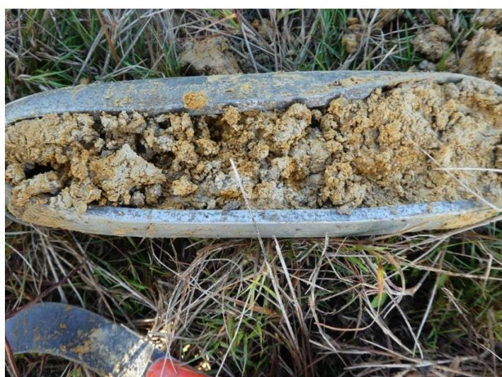
*Exemple de traces d'hydromorphie très nettes dans un sondage réalisé sur la zone « extension NORD » : la couleur « rouille » correspond au phénomène d'oxydation et le gris clair au phénomène de déferrification.*
